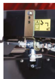
Odnímatelný zadní hydraulický nosič nářadí s tříbodovým připojením, vhodný pro přepravu zařízení, jako jsou jeřáby, lesnické nakladače, navijáky, štípače dřeva atd. Removable rear hydraulic tool carrier with three-point connection, suitable for transporting equipment like cranes, forestry loaders, winches, log splitters, etc.
