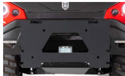
Přední deska pro upevnění nářadí se spojkou skupiny 3 DIN B. Front tool fixing plate with DIN B group 3 coupling
