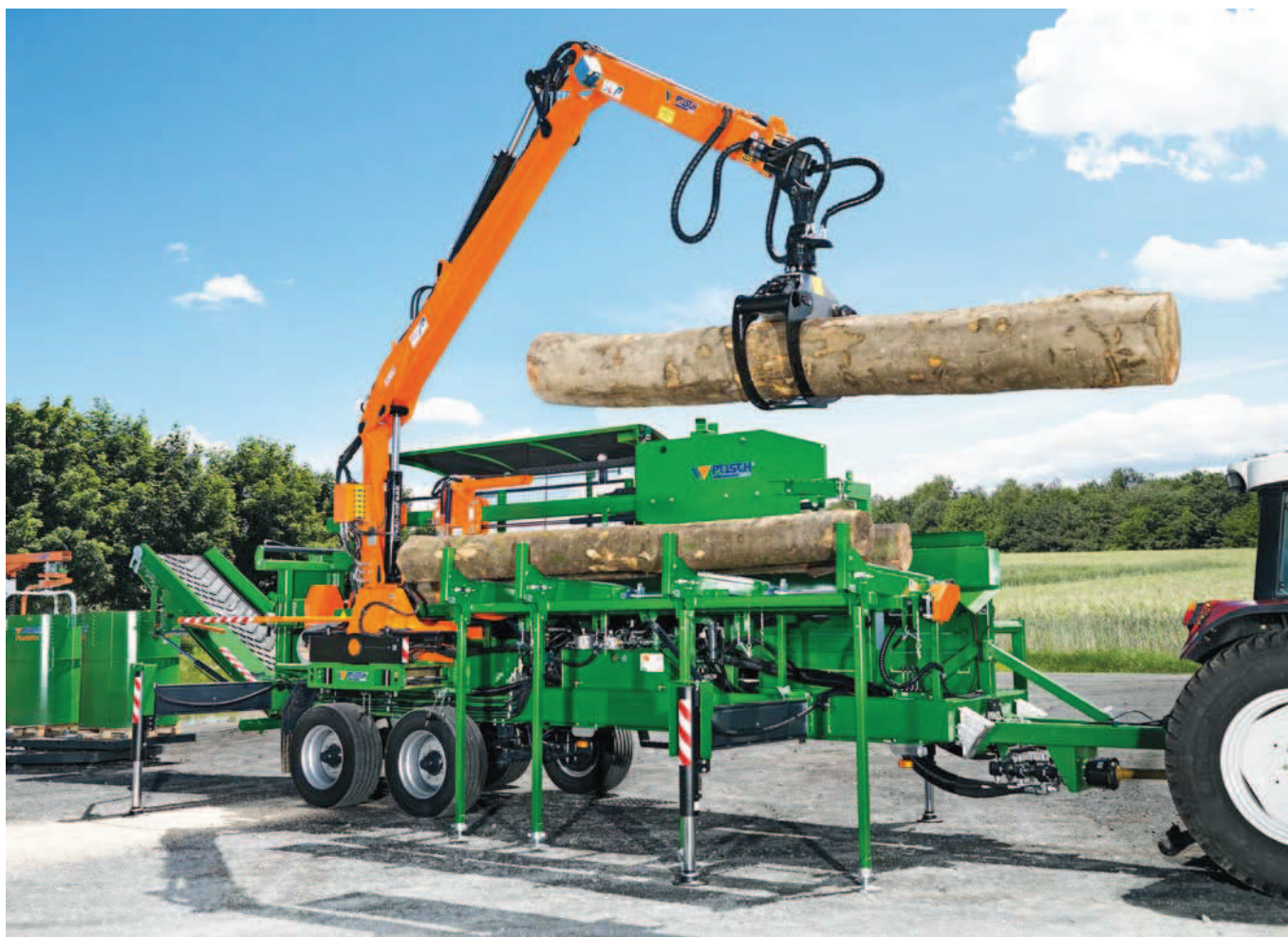
Mobilní SpaltFix K-550 Spezial s jeřábem pro nakládání dřeva a lomeným pásovým dopravníkem pro dopravu hotového dřeva.
