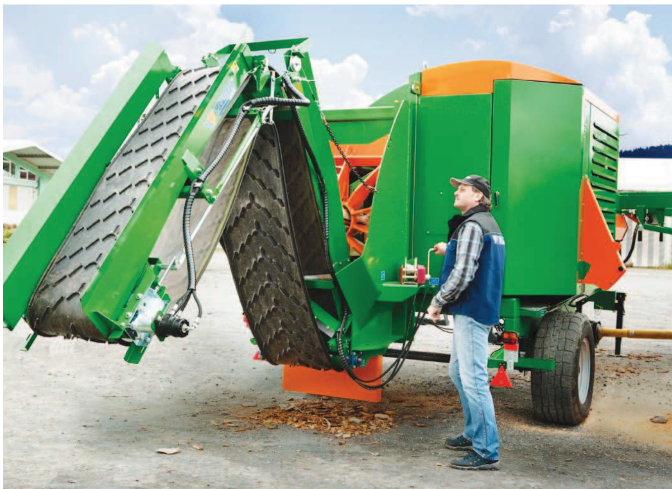
Volitelný lomený pásový dopravník je k dispozici v délce 4 m, resp. 6 m. V přepravní poloze jej lze snadno (ručně nebo hydraulicky) a s úsporou místa sklopit ke stroji.
