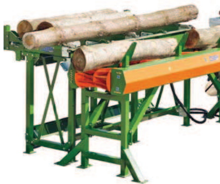
Nakládací systém: Příčný dopravník zde v kombinaci s válcovým dopravníkem.
