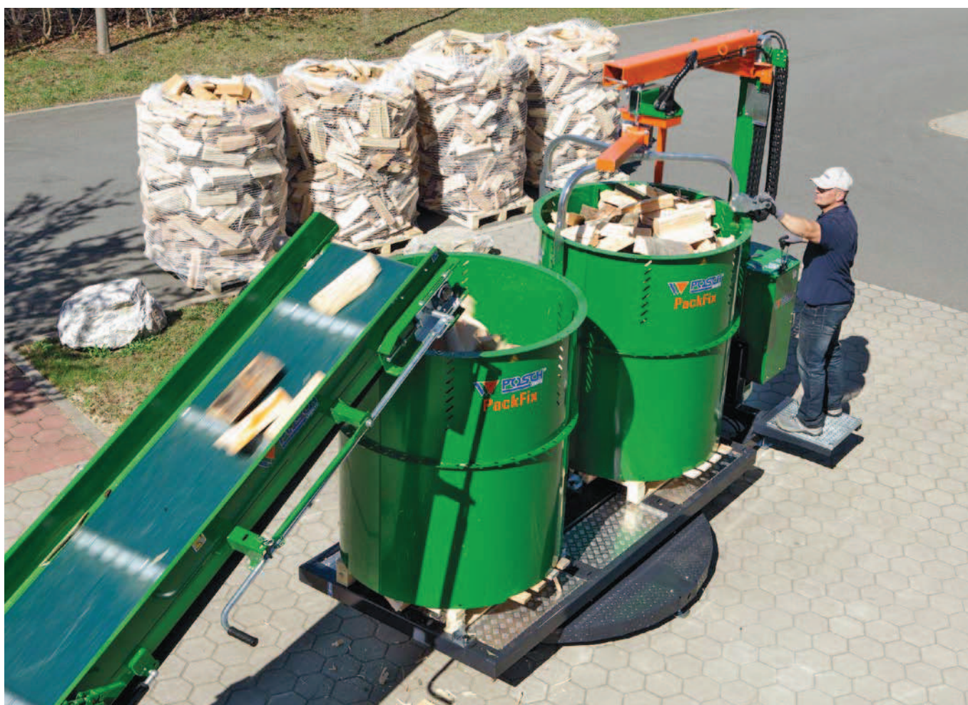
Řešení pro balení štípaného dřeva: PackFix s hydraulickým otočným stolem pro efektivní výrobu palivového dříví.
