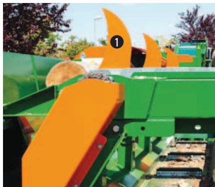
Nakládací systém: Příčný dopravník. Volitelná rozdělovací hvězdička 1 předává kmeny jednotlivě na podélný dopravník.
