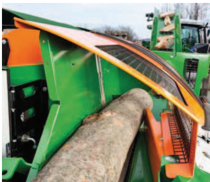
Hydraulický přídržovač brání vzpříčení kusu dřeva.
