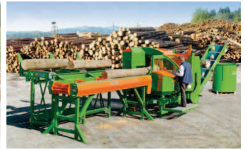
Výpočet výkonu stroje SpaltFix K-440 Spezial Základ: 240 cyklů/h
