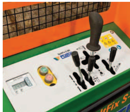
Jednoruční ovládání joystickem pro komfortní obsluhu a volitelná funkce Saw-Control pro automatické sledování otáček pilového kotouče.
