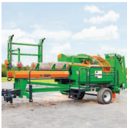
SpaltFix K-540 lze volitelně pohodlně přepravovat pomocí traktorového podvozku.
