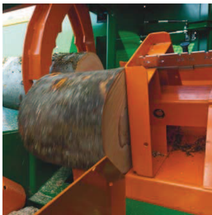
Optimální předávání dřeva z oblasti pily díky hydraulické kolébce.
