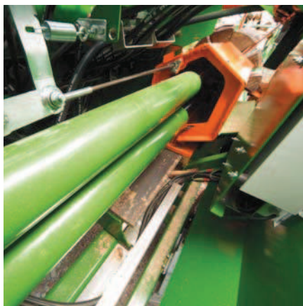
Silná a rychlá. Dvouválcový systém zajišťuje dvojnásobně rychlý zpětný chod a tím vyšší hodinový výkon.
