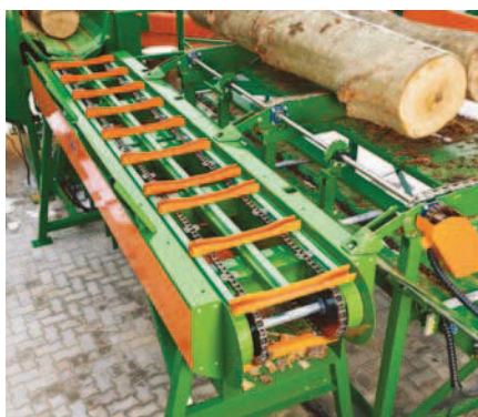
Dvojité řetězové dopravníky pro SpaltFix K-540 a SpaltFix K-600 Vario.
