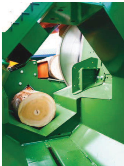
Systém OnlyCut: SpaltFix S-360 lze využívat také jako vysoce výkonnou pilu bez štípacího nože.
