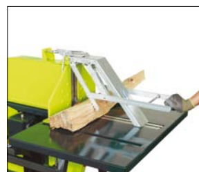
Stůl na kolech s kuličkově uloženým vedením
