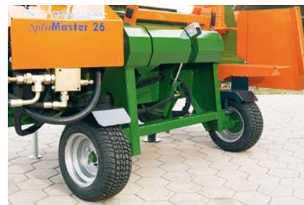
Traktorový podvozek DT s odnímatelnou ojí pro SplitMaster.
