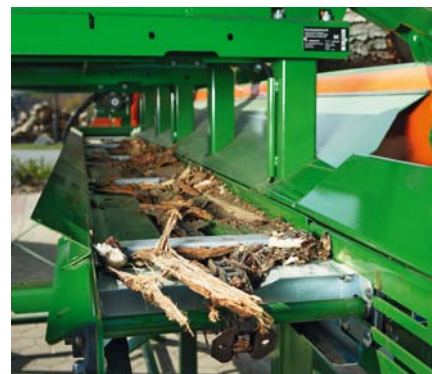
Doplňkové vybavení: Volitelný čistící pás dopravuje dřevěný odpad pod příčným dopravníkem do libovolného kontejneru.
