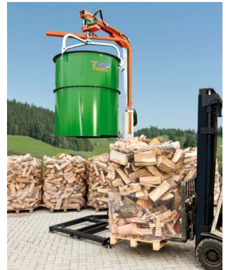
Když je plnicí buben úplně vytažený nahoru, je možné hotový „balík dřeva“ odvézt.
