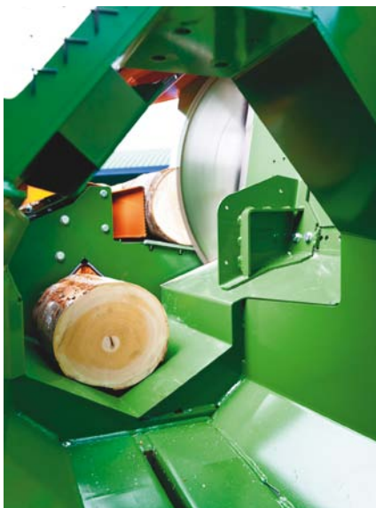
Systém OnlyCut: SpaltFix S-360 lze využívat také jako vysoce výkonnou pilu bez štípačního nože.
