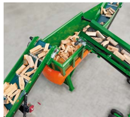
LogFill slouží jako zásobník polenového dřeva a zajišťuje tak bezproblémové procesy v logistice palivového dřeva.
