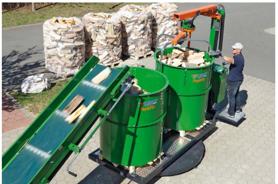
Úspora času: Během plnění jednoho bubnu může být dřevo ve druhém již baleno a následně dopraveno ven. Poté je k plnění opět připraven nový buben (volba TH).
