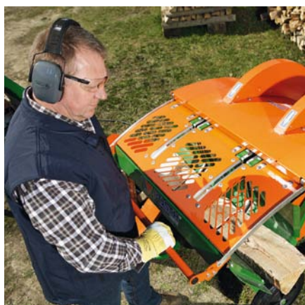
Integrovaný ochranný kryt zabraňuje nechtěnému kontaktu s pilovým kotoučem během řezání.
