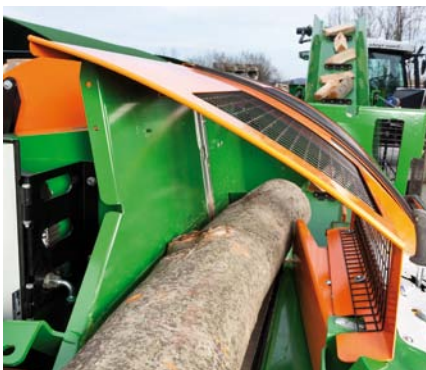
Hydraulický předřovač brání vzpříčení kusu dřeva.
