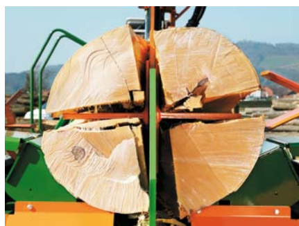
Hydraulicky nastavitelný štípací nůž pro silové štípání dřeva.
