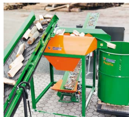
Volitelný pásový dopravník pod sítím předává odpad do libovolného kontejneru. Čistá polena zde padají do plnicího bubnu PackFix.
