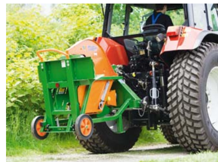
Výkyvnou pilu lze prostřednictvím tříbodového zavěšení pohodlně a rychle přepravit na místo jejího použití.
