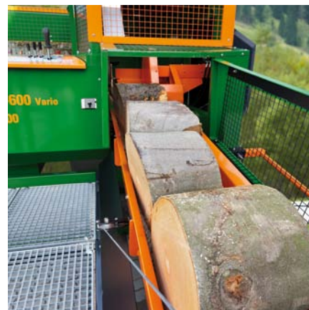
Kulatina se prostřednictvím kolébky předává přes 2 m dlouhý zásobníkový pás k zařízení AutoSplit
