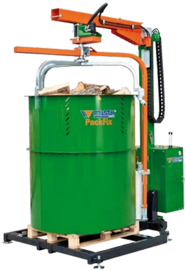
PackFix Hydro stacionární, sériově se spodním rámem s možností nivelace (UR)
