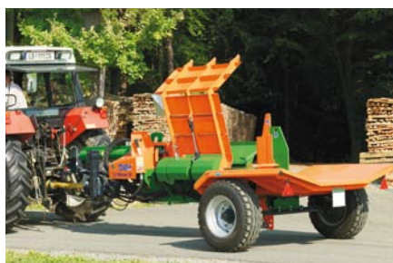
SplitMaster 30 s podélným traktorovým podvozkem pro mobilní použití.
