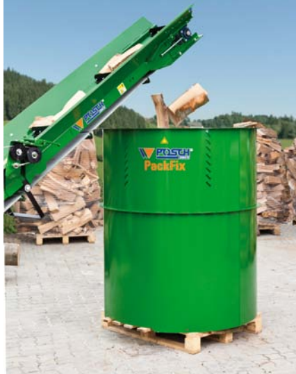
Buben PackFix se plní pomocí dopravního pásu.
