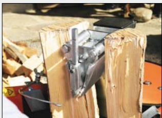
Nasazovací štípací nůž s válečky (sériově u strojů SpaltAxt 8 Spezial a SpaltAxt 10 Spezial) šetří při štípání sílu. Dřevo rychle praskne a válečky na štípacím noži zabrání zaklínění naštípaného dřeva při zpětném chodu.
