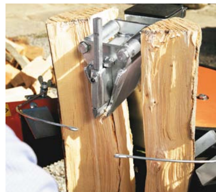
Nasazovací štípací nůž s válečky šetří sílu při štípání. Dřevo rychle praskne a válečky na štípacím noži zabrání zaklínění naštípaného dřeva při zpětném chodu.
