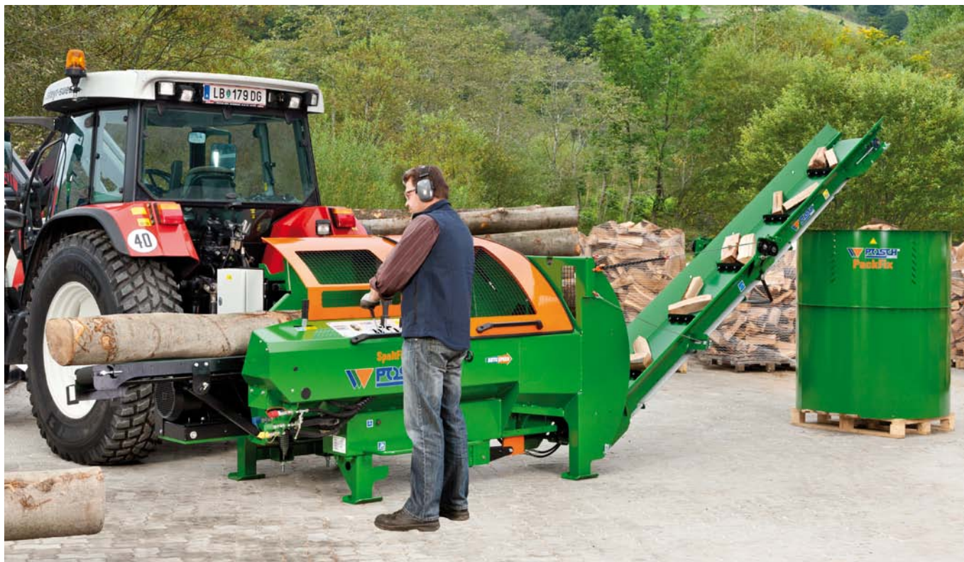
SpaltFix S-360 ZE22D s lomeným pásovým dopravníkem pro dopravu dřeva na výstupu a řešením balení PackFix pro optimální balení palivového dřeva.
