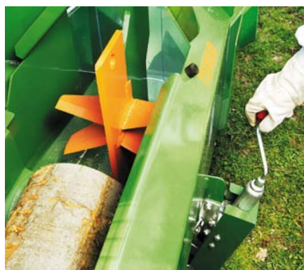
Výšku štípacího nože lze lehce přestavovat rukou.
