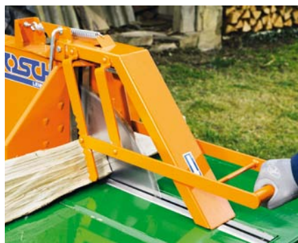
Vedení stolu s lehkým chodem a uložením na kuličkových ložiscích pro optimální pohodlí obsluhy.
