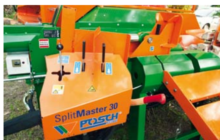
Dvouruční ovládání. Joystick pro zdvihací zařízení a nastavování nože.
