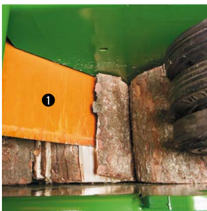
V jádru stroje štípe štípací nůž ve tvaru písmene V 1 ve 3sekundovém rytmu kulatínu a hranoly a zpracovává je na podpalové třísky připravené na zátop.
