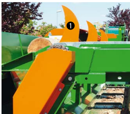
Nakládací systém: Příčný dopravník s volitelnou rozdělovací hvězdice 1 předává kmeny jednotlivě na podélný dopravník.
