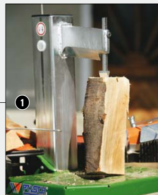
Pomocí hrotu pro upevnění dřeva lze snadno a bez námahy upevnit i tenké nebo šikmo odříznuté dřevo.
