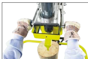
Sériově dvouruční bezpečnostní zapínání
