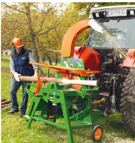
Stroj SchälProfi umožňuje snadné odkorňování s následným špičatěním kmenů.
