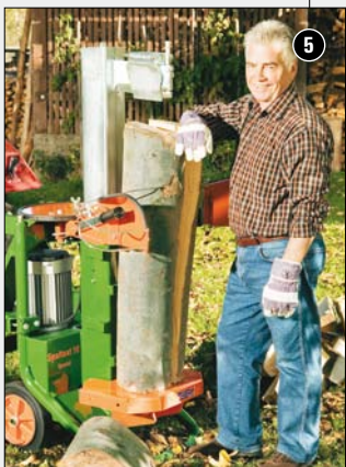
Speciální provedení umožňuje i občasné štípání metrového dřeva (štípací zdvih 54 cm).
