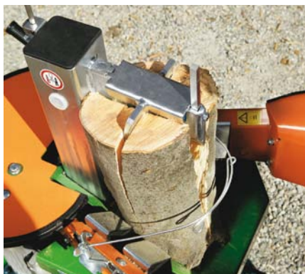
Štípací kříž pro SpaltAxt 8 (F0002543) bez námahy zvládne čtyři polena v jednom pracovním kroku.
