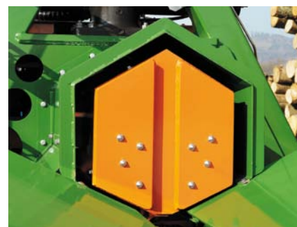
Lisovník protlačuje štípané dřevo štípacím nožem silou větší než 40 / 55 t.
