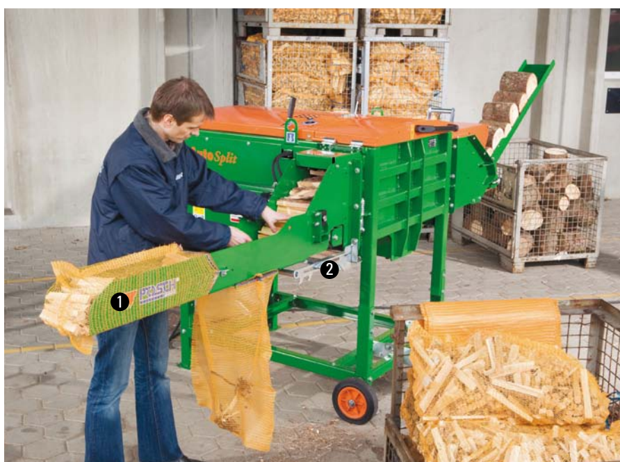
● AutoSplit 250 s balícím korytem pro vrstvené balení.
