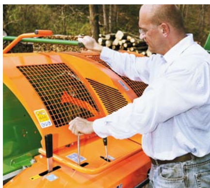
Ovládání přídržovače dřeva a pilového kotouče se provádí pomocí ergonomického ručního posuvu.
