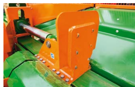
Velký tlačný prvek pro problematické dřevo s o 40 % delším vedením pro delší životnost
