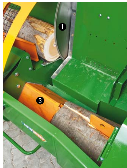
Srdce štípačky SpaltFix S-360: ❶ Pilový kotouč WIDIA Ø 900 mm s hydraulickým posuvem ❷ Automaticky rozevírající doraz brání vzpříčení dřeva ❸ Kopyto tlačí dřevo štípací silou 12 t přes dvoubřitý štípací nůž
