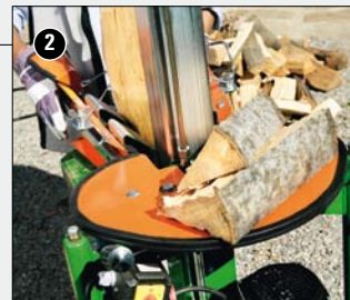
Sériový odkládací stůl slouží k dočasnému odložení polena během štípání.
