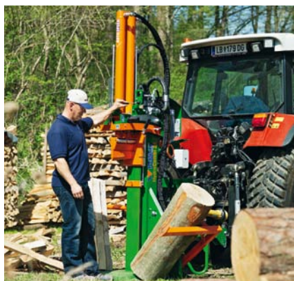
Hydraulické zařízení pro zvedání kmenů pro větší komfort obsluhy.
