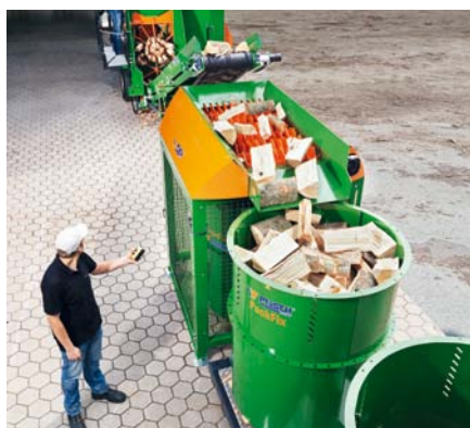
LogFix s volitelným zajištěním přístupu (Z): Kvalitní palivové dříví obratem ruky. Pomocí rádiového dálkového ovládní lze LogFix pohodlně vypnout a zapnout.
