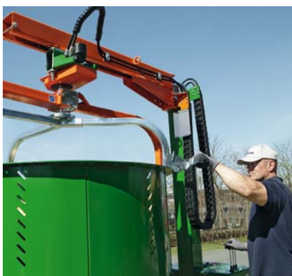
Plnicí buben lze rukojetí snadno odpojit od rámové konstrukce.
