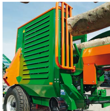
Ochrana proti nárazu u SpaltFix K-440 sériově.
