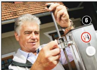
Štípací zdvih lze plynule nastavovat.
