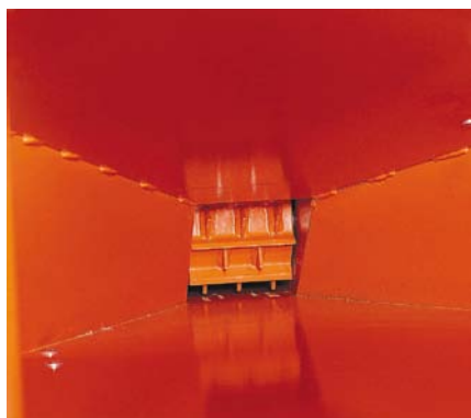
Přívod materiálu pro sekání probíhá přes vtahovací válec.
