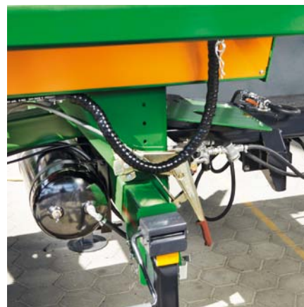
Traktorový podvozek s vzduchotlakovou brzdou.
