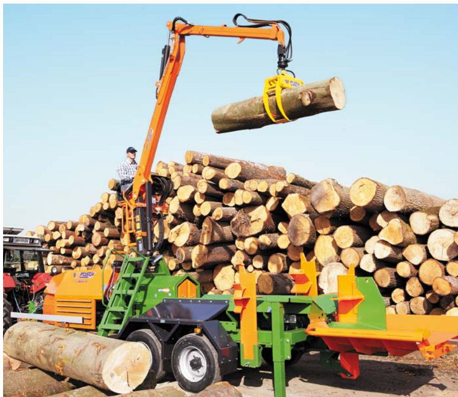
SplitMaster 55 Crane. Nakládací jeřáb zvedá kmeny o hmotnosti až 1 200 kg do štípacího korýta.
