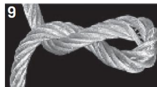
Toto lano se zkrátilo ve směru otáčení lana. V nezatiženém stavu tvoří smyčku ve směru odvíjení lana.
