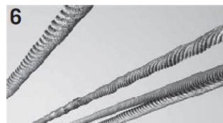
Ocelová lana se formují do tvaru vrtáku, protože se ocelové lano dře o části konstrukce, nebo se vleko skrze příliš úzké drážky.
