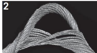
Kvůli rotaci (zkroucení) ve směru otáčení ocelového lana se „nekroutivé“ ocelové lano zkrátilo a jádro prodloužilo.
