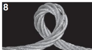
Toto lano se zkrátilo ve směru otevírání (odvíjení) ocelového lana. V nezatiženém stavu tvoří smyčku ve směru otáčení lana. Po zatížení lana se smyčka utáhne a může trvale změnit tvar lana.
