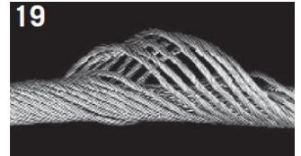
Vznik košíku na nekroutivém ocelovém laně. Pokud jste viděli jedno, viděli jste všechny.
