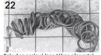
22 Pokud se ocelové lano táhne přes ostré hrany, má sklon se v nezátěženém stavu navíjet.
