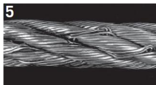
Na tomto šesti pramenném laně se kvůli kroucení povolily vnější vrstvy drátů vnějších pramenů.
