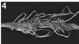
Časté kroucení ovlivňuje jenom vnitřní (nejkratší) pramen. Ten jediný leží natažený na ocelovém laně.
