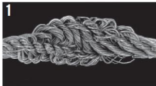
Ocelové lano po „oloupání“ vnějších pramenů. Dobře viditelné hromadění přebytečných délek
