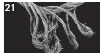
Toto lano se zcela rozvinulo. Vnější prameny jsou pro ocelové lano příliš dlouhé. Tam, kde kladkostroj tlačil na přebytečné prodloužení, stojí prameny zpříma.
