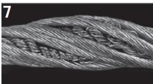
Kvůli kroucení lana o kladkostroj se prameny v jádře lana přebytečně prodloužily. Taková poškození se mnohokrát nachází na koncích pohybu lana, které je vedeno přes kladkostroje nebo bubny.
