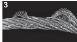
Ocelová lana s dvojitým souběžným navinutím pramenů jsou citlivá na zkroucení. Zde došlo k prodloužení vnitřních pramenů, což je vytlačilo ven.
