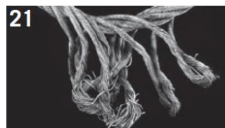
21 Toto lano se zcela rozvinulo. Vnější prameny jsou pro ocelové lano příliš dlouhé. Tam, kde kladkostroj tlačil na přebytečně prodloužení, stojí prameny zpřima.
