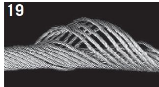
19 Vznik košíku na nekroutivém ocelovém laně. Pokud je vidět jedno, jsou vidět všechny.
