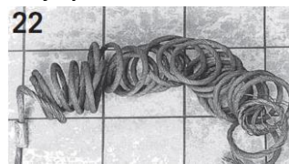
22 Pokud se ocelové lano táhne přes ostré hrany, má sklon se v nezatiženém stavu navíjet.
