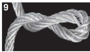
9 Toto lano se zkrutilo ve směru otáčení lana. V nezatiženém stavu tvoří smyčku ve směru odvíjení lana.
