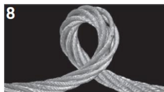
8 Toto lano se zkrutilo ve směru otevírání (odvíjení) ocelového lana. V nezatiženém stavu tvoří smyčku ve směru otáčení lana. Po zatížení lana se smyčka utáhne a může trvale změnit tvar lana.
