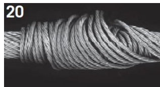
20 Ještě jedno vytvoření košíku na nekroutivém laně.
