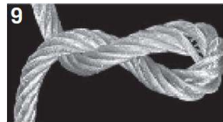
9 Toto lano se zkroutilo ve směru otáčení lana. V nezatiženém stavu tvoří smyčku ve směru odvíjení lana.
