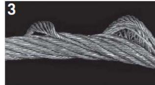
3 Ocelová lana s dvojitým souběžným navinutím pramenů jsou citlivá na zkroutení. Zde došlo k prodloužení vnitřních pramenů, což je vytlačilo ven.
