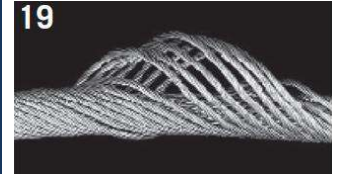
19 Vznik košíku na nekroutivém ocelovém laně. Pokud jste viděli jedno, viděli jste všechny.
