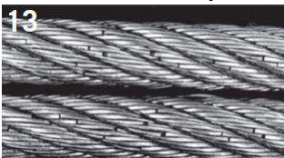
13 Zlámání drátů na ocelových laněch se zavěšenými prameny způsobené vyčerpáním.
