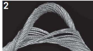
2 Kvůli rotaci (zkroutení) ve směru otáčení ocelového lana se „nekroutivé“ ocelové lano zkrátilo a jádro prodloužilo.
