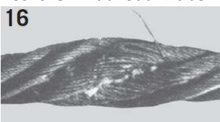
16 Zploštění z důvodu mačkání. Poškození jsou trvalá.
