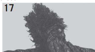
17 Při zatížení vzniklých smyček dojde k zlomení vláken a deformacím.
