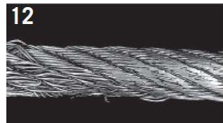
12 Příliš široký kladkostroj špatně podepírá ocelové lano. Následkem je rychlé zlámání drátů na styčném povrchu.
