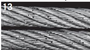
Zlámání drátů na ocelových lanech se zavřenými prameny způsobené vyčerpáním.
