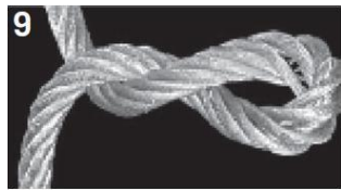
Toto lano se zkroutilo ve směru otáčení lana. V nezatiženém stavu tvoří smyčku ve směru odvíjení lana.
