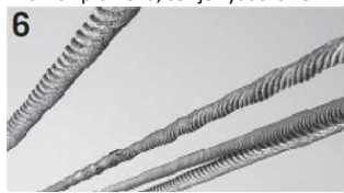
Ocelová lana se formují do tvaru vrtáku, protože se ocelové lano dělo o části konstrukce, nebo se vleklo skrze příliš úzké drážky.
