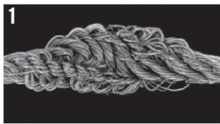
Ocelové lano po „oloupání“ vnějších pramenů. Dobře viditelné hromadění přebytečných délek
