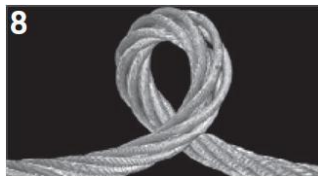
Toto lano se zkroutilo ve směru otevírání (odvíjení) ocelového lana. V nezatiženém stavu tvoří smyčku ve směru otáčení lana. Po zatížení lana se smyčka utáhne a může trvale změnit tvar lana.
