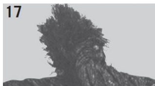
Při zatížení vzniklých smyček dojde k zlomení vláken a deformacím.
