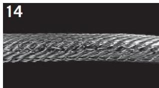
Toto nekroutivé ocelové lano bylo taženo přes okraj kladkostroje, a tím se hodně poškodilo.
