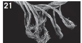
Toto lano se zcela rozvinulo. Vnější prameny jsou pro ocelové lano příliš dlouhé. Tam, kde kladkostroj tlačil na přebytečně prodloužení, stojí prameny zpříma.
