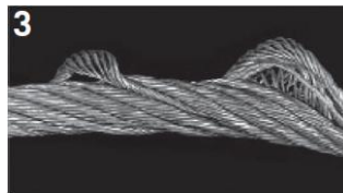
Ocelová lana s dvojitým souběžným navitím pramenů jsou citlivá na zkroucení. Zde došlo k prodloužení vnitřních pramenů, což je vytlačilo ven.
