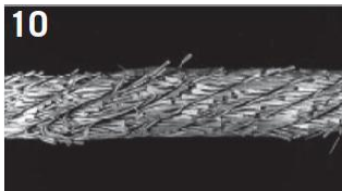
Toto ocelové lano pracovalo v příliš úzkém kladkostroji.
