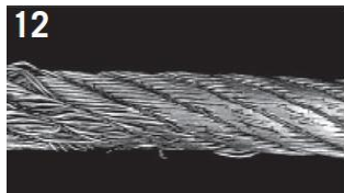
Příliš široký kladkostroj špatně podepírá ocelové lano. Následkem je rychlé zlámání drátů na styčném povrchu.
