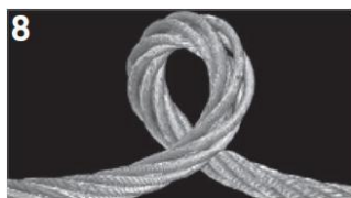
8 Toto lano se zkrátilo ve směru otevírání (odvíjení) ocelového lana. V nezátíženém stavu tvoří smyčku ve směru otáčení lana. Po zatížení lana se smyčka utáhne a může trvale změnit tvar lana.
