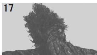
17 Při zatížení vzniklých smyček dojde k zlomení vláken a deformacím.
