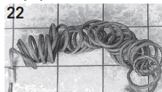
22 Pokud se ocelové lano táhne přes ostré hrany, má sklon se v nezátíženém stavu navíjet.
