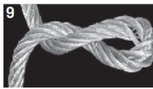
9 Toto lano se zkrátilo ve směru otáčení lana. V nezátíženém stavu tvoří smyčku ve směru odvíjení lana.
