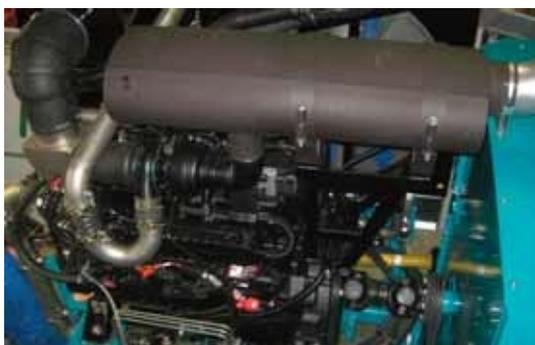
Ein John-Deere-Motor mit 405 PS treibt den Hacker und den Holzkran an. Diese kompakte Bauweise mit einem 3 m langen Einzugsband und einer 1,5-m-Gossenverlängerung ist ideal für langes Baumwipfelzeug, Prozessorabfall und Spreißelholz etc.
